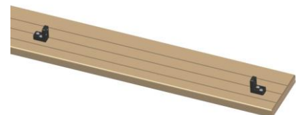
Figur 11 Et endeklips for hver bjelke
