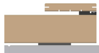
Figur 6 Skyv leppene inn i holderne på underkonstruksjonen
