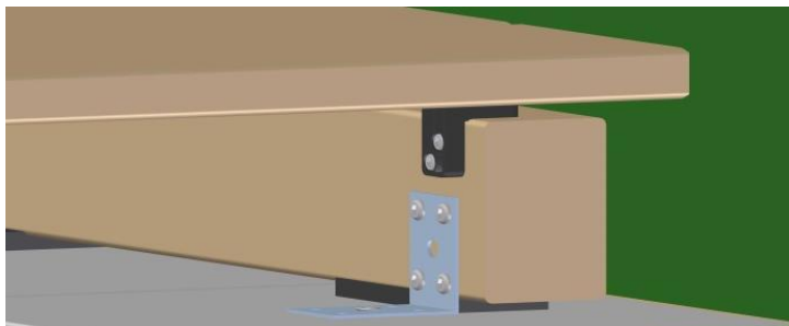
Figur 12 Endeklipset skrues fast på underkonstruksjonen
