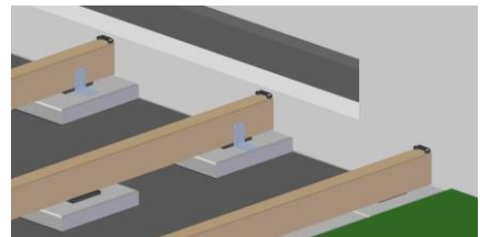
Figur 2 Monter en holder på hver bjelke
