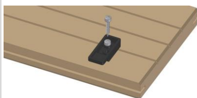
Figur 5 Monter startklips på undersiden av det første terrassebord
