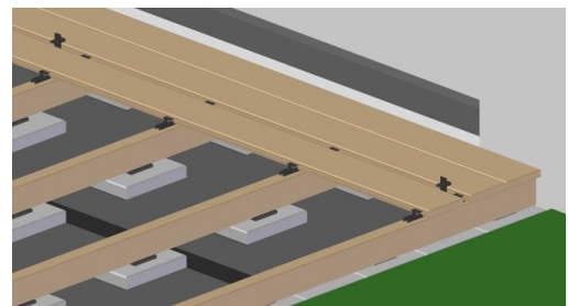
Figur 9 Montering av påfølgende bord
